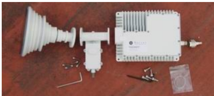
LNB, Alimentador y BUC de Norsat
